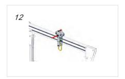
Cierre la placa del carro que encapsula la viga e inserte el pasador del avión / bloqueo de bola. Observe que el pasador está enganchado correctamente a través de los agujeros.
