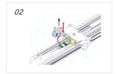
Gire la placa inferior para abrir el carro y levante el pasador de seguridad.
