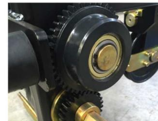
El bloque de la rueda adopta el diseño del módulo para el mantenimiento y el cambio convenientes, y la rueda y el eje cargado adoptan el acero de aleación de la alta calidad forjar, procesar y tratar el calor cojinetes con vida de servicio alta y confiabilidad.
