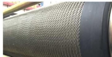
El cable de alambre importado de alto rendimiento con resistencia a la tracción hasta 2160MPa. La superficie con el proceso galvanizado para la prevención de la corrosión con eficacia. Con buena flexibilidad para asegurar la resistencia al desgaste del cable y prolongar su vida útil.
